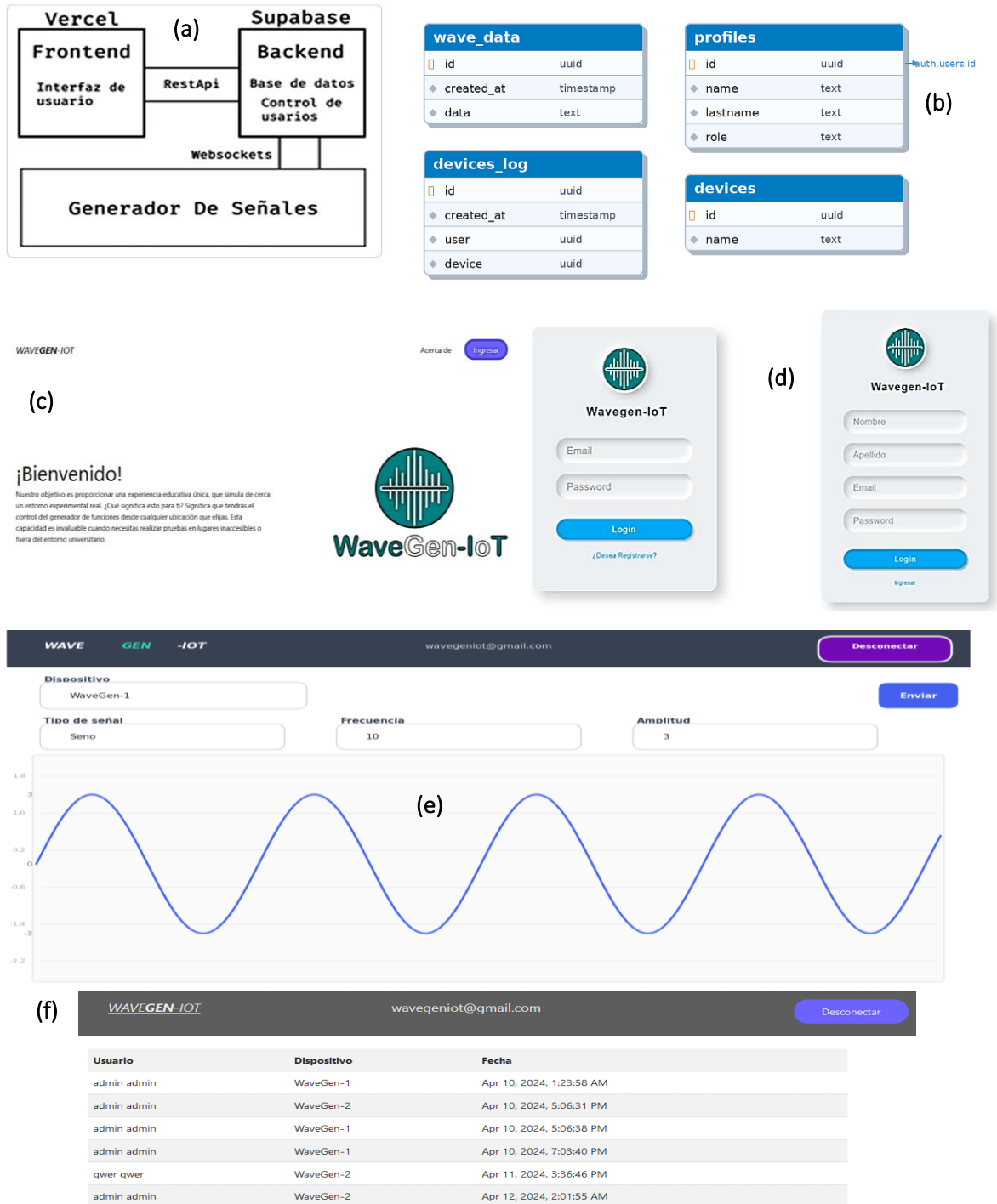
Figura 1 Interfaz y arquitectura del sistema WaveGen-IoT
